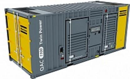
Такое решение позволяет работать как одному генератору в отдельности, так и двум в параллель, поставляя мощность в 1000 кВА. Таким образом, достигается существенное снижение расхода топлива и других эксплуатационных расходов на объектах где потребление электричества изменяется в широких пределах. Так же это позволяет избежать преждевременного выхода из строя дизельных двигателей при длительной эксплуатации с низкой загрузкой.
