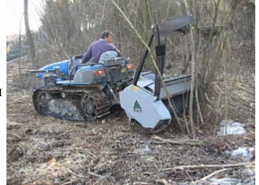
Низкорасположенный вал отбора мощности позволяет кардану работать при оптимальном угле, а корпус усилен для осевых нагрузок при повороте гусеничного трактора. Это позволяет избежать повреждений корпуса и некоторых компонентов, например, подшипников и втулок ротора.
