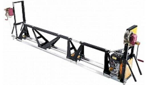
Малоподвижная бетонная смесь обладает большим сопротивлением и требует применения мощной виброрейки типа ВТ90. Но большая мощность одновременно означает, что виброрейка обладает большей массой. Именно из этих соображений модель SV-flex была разработана с учетом сохранения малой массы.
